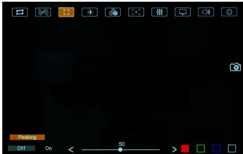
Verwenden Sie diese Option, um die Peaking-Funktion zu aktivieren oder zu deaktivieren. Diese Funktion hilft dem Kameramann, ein möglichst scharfes Bild zu erhalten.
