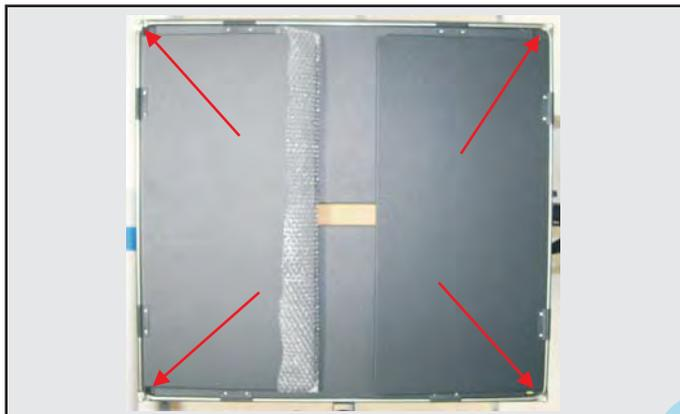
Demontieren Sie die Spiegelklappen durch entfernen der Schrauben in den vier Ecken.
